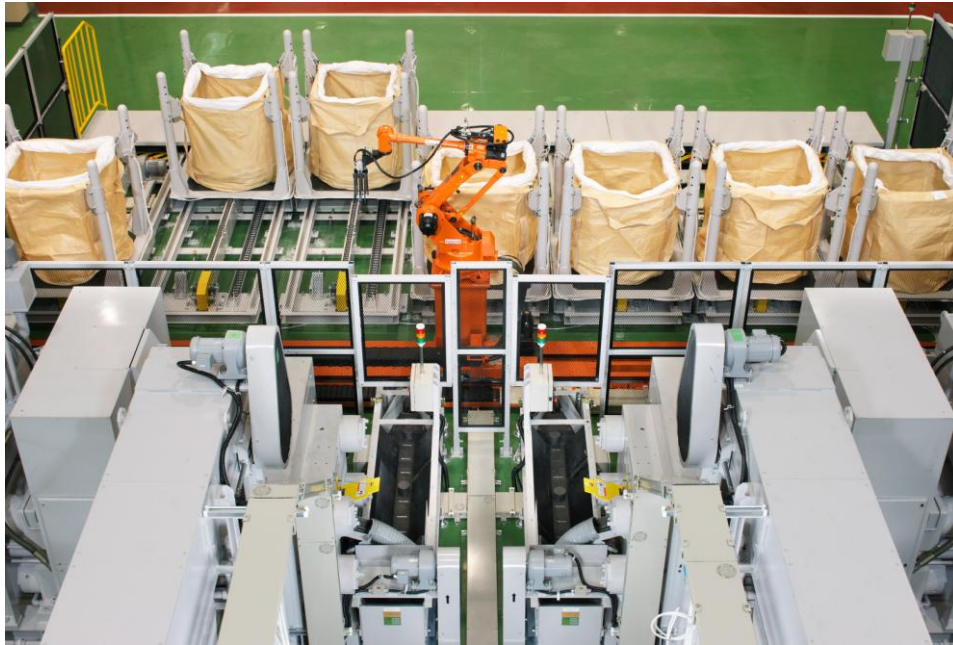
鋳物切屑の自動回収システムを導入
