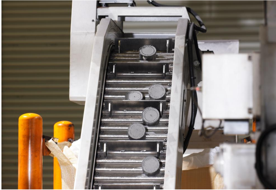
プレス装置による固形化システムも合わせて導入し、リサイクルも実現
