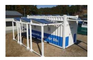
※ ライフイノベーションコンテナ:コンテナの屋根に設置されたソーラーパネルで 1 日平均 6.7Kwhを発電、内部には 48 個の蓄電池と電力制御装置を備え 無日照の日が 3~4 日続いても給電が可能なほか、どこにでも輸送・設置が可能。
