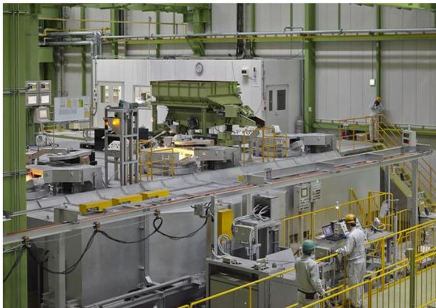
品質については、最新造型機、自動注湯機の導入により鑄造品質の向上を図っています。省人化については、鑄造型交換作業を自動化することにより、要員削減及び安全面でも向上しました。そして、全工程のラインを一本化した「リフトレス」の工場となっております。
